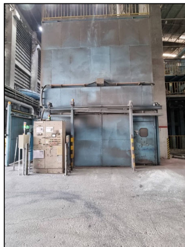
ภาพที่ 2.9 ห้องครอบเสียงเครื่องขัดชิ้นงานอัตโนมัติ
